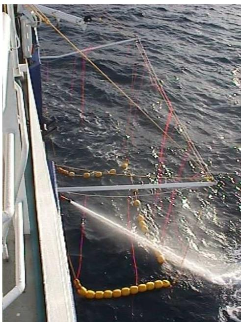
Figure 3 : Dispositif d'effarouchement des oiseaux utilisé avec succès sur le navire de pêche *Janas*.
