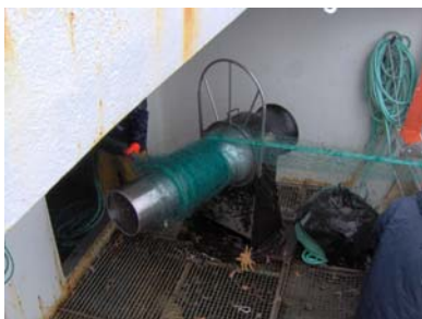
Figura 1: Tambor o rodillo para recoger la red de enmalle
